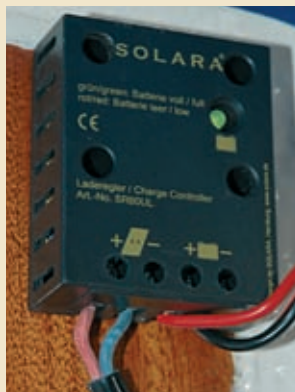
Når solpanelet lader på batteriet lyser den lille lampe GUL og når batteriet er fuldt opladet bliver lampen GRØN som her.
