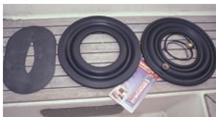
Komplet sæt med manchetter og indre og ydre vulkaniseret gummimembran. Dipol med stik og kontaktlim. Sættet koster ca. 6.000 kr.
