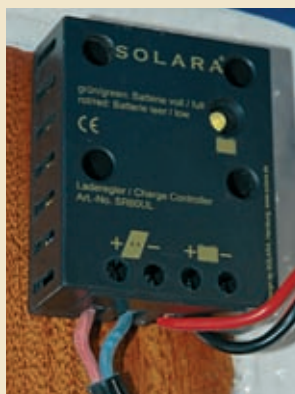
Den lille regulatorboks på 4 amp kan placeres hvor som helst under dæk. De små symboler viser ledningernes placering.
